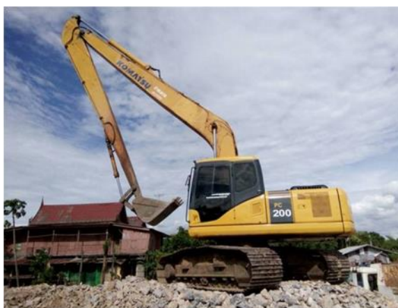
ภาพที่ 1 รถขุด-ตัก KOMATSU PC 200 ที่มา: โชคชัย อลงกรณ์ทักษิณ (2553)
